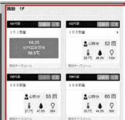
システムの画面にはセンサーによる高齢者の動作や心拍数のほか、室温や湿度なども表示される（イメージ、写真上）。AIが高齢者の離床を予測し介護職員の端末に通知する
